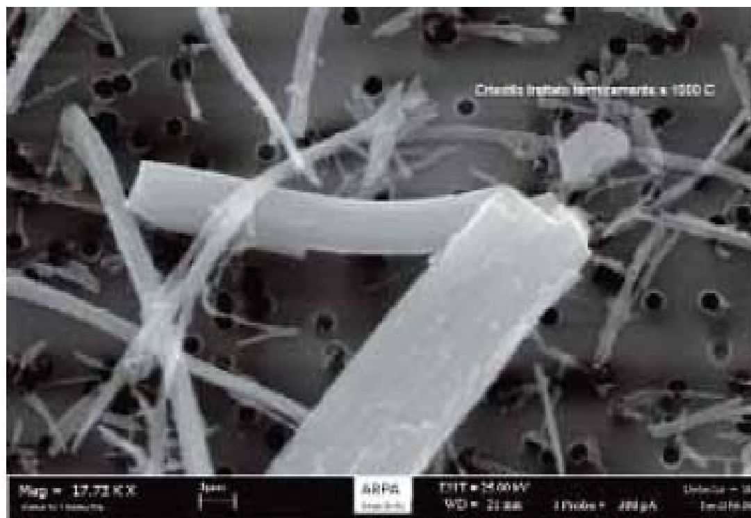
Fig.:Immagine SEM di fibre trattate di crisotilo Fonte: Pecchini, Renna, Sala, Bacci, Paoli, Biancolini ARPA Emilia Romagna
