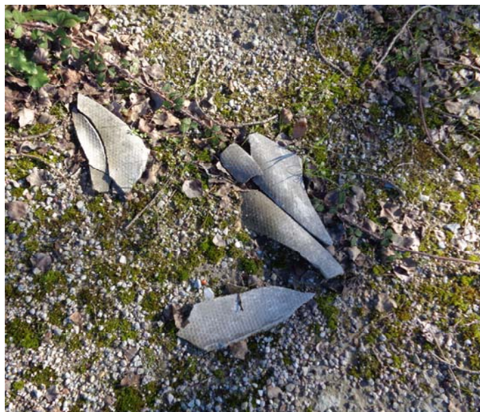
FOTO N°22–23 - Vista ravvicinata dei frammenti di lastre in cemento amianto (eternit)
