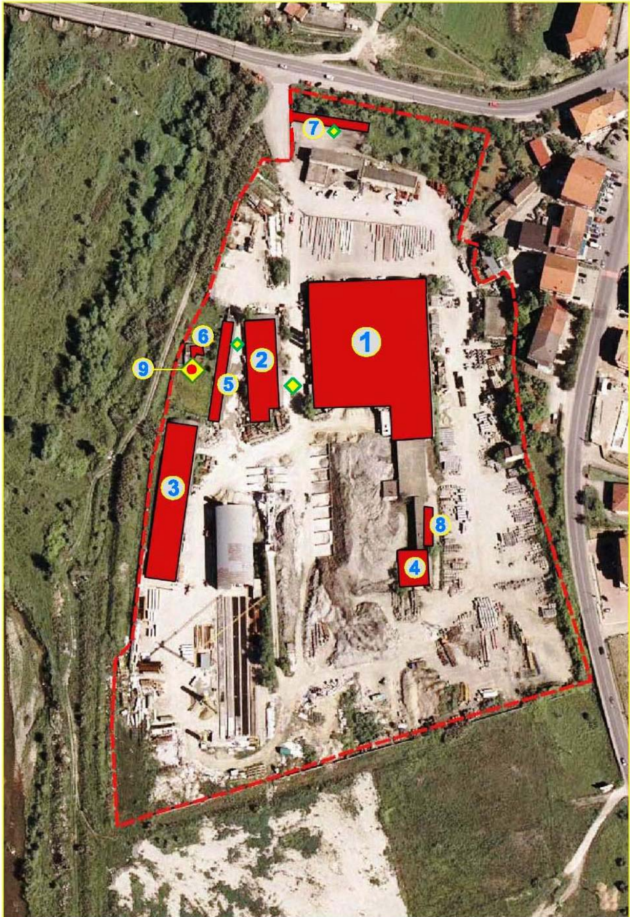
FIG. N°3 - Indicazione particolareggiata delle coperture in cemento amianto e della loro tipologia geometrica - sc. 1:2000
