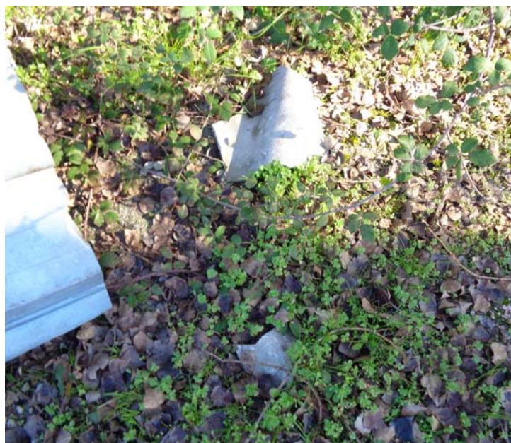
FOTO N°22–23 - Vista ravvicinata dei frammenti di lastre in cemento amianto (eternit)
