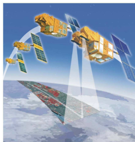
Figura 2 - Immagine del satellite SPOT raffigurante la scansione di una fascia del territorio e rappresentazione in falsi colori.
