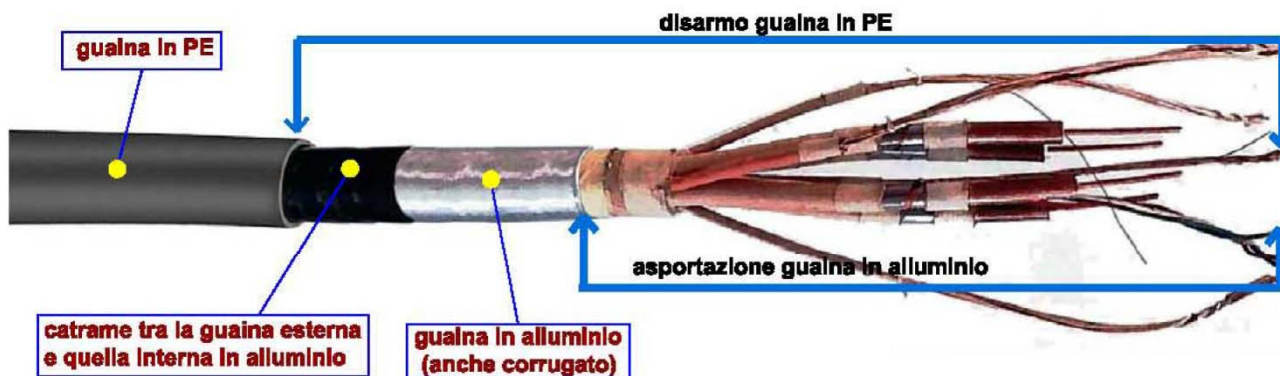
Fig. n°5 - Immagine del coassiale con indicazione delle parti da asportare
