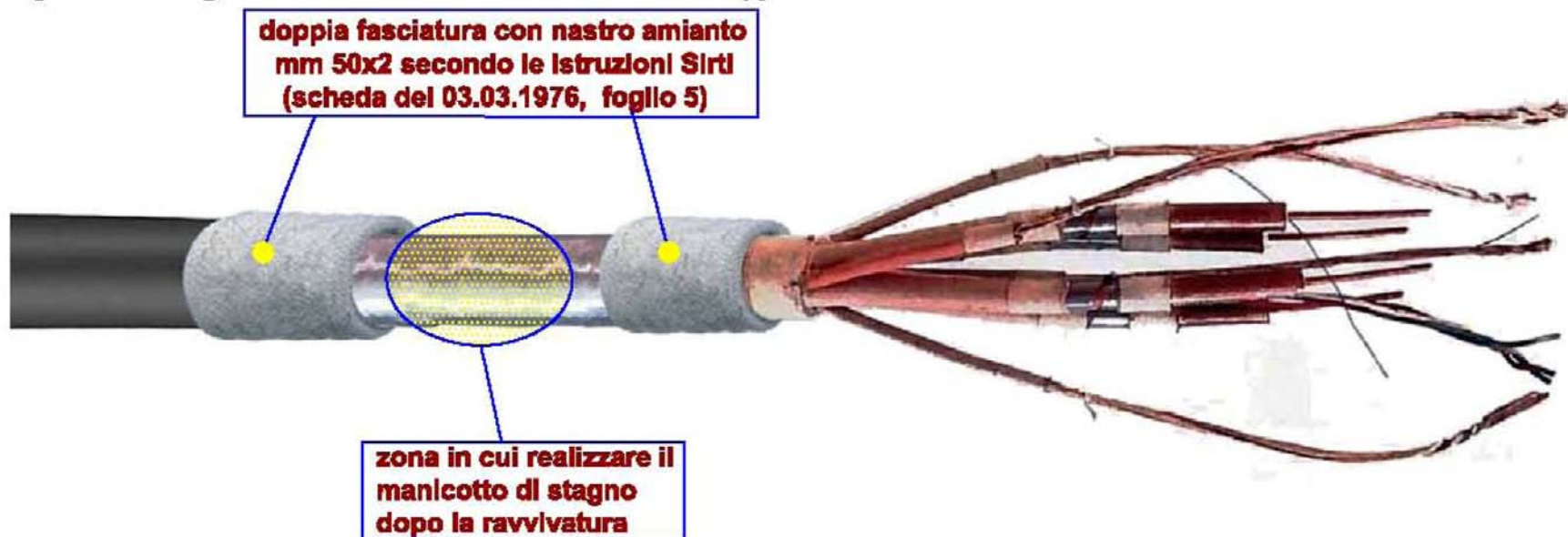
Fig. n°7 - Immagine del coassiale con indicazione della doppia fasciatura con nastro d'amianto secondo schede Istruzioni Sirti
