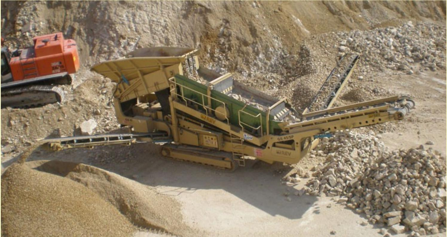
Gruppo mobile di vagliatura per selezione pesante con equipaggiamento da sgrossatore, o per selezione finale con piani in rete. Ampia tramoggia con alimentatore a piastre. Ideale per il trattamento di materiale di riciclaggio o naturale di scavo.
