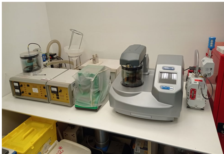
Metallizzatore: deposita strati sottili e uniformi di oro, platino o grafite in maniera completamente automatica su campioni da analizzare per la preparativa delle analisi al SEM
