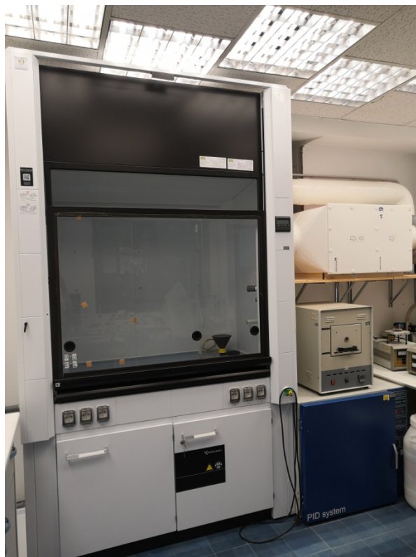
Cappa chimica con filtro EPA per preparazione campioni per la ricerca di fibre di amianto
